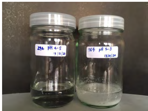
รูปที่ 3-4 สารละลายไซเลนที่ใช้ n -octyltriethoxysilane (ซ้าย) และสารละลายไซเลนที่ใช้ hexadecyltrimethoxysilane (ขวา) สูตรที่ 3
