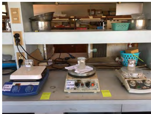
รูปที่ 3-6 เส้นใยนาโนเซลลูโลสที่ทำการดัดแปรด้วย hexadecyltrimethoxysilane
