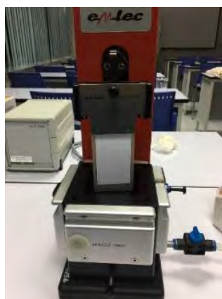
รูปที่ 3-12 การทดสอบด้วยเครื่องวิเคราะห์การแพร่ผ่านแบบไดนามิกส์
