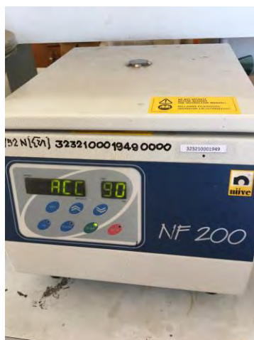
รูปที่ 3-7 เครื่องปั่นเหวี่ยงความเร็วสูง
