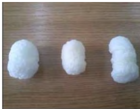
รูปที่ 2.14 โฟมที่ขึ้นรูปโดยผสมกับสารเติมแต่งคือ poly(vinyl) alcohol โดยใช้แป้งต่างชนิดกัน คือ แป้งสาลี แป้งข้าวโพด และแป้งมัน เรียงจากซ้ายไปขวา
