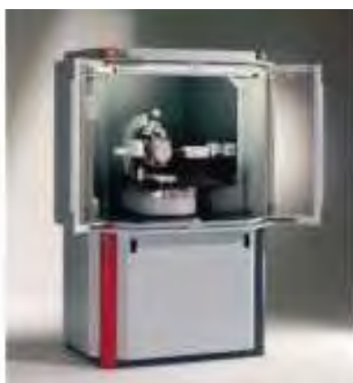
รูปที่ 3.2 เครื่อง X-ray diffractometer ยี่ห้อ Bruker รุ่น D8 Advance
