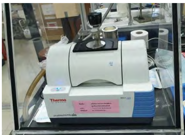
รูปที่ 3.5 เครื่อง Fourier transform infrared spectrophotometer ยี่ห้อ Thermo Fisher รุ่น Spectrum One
