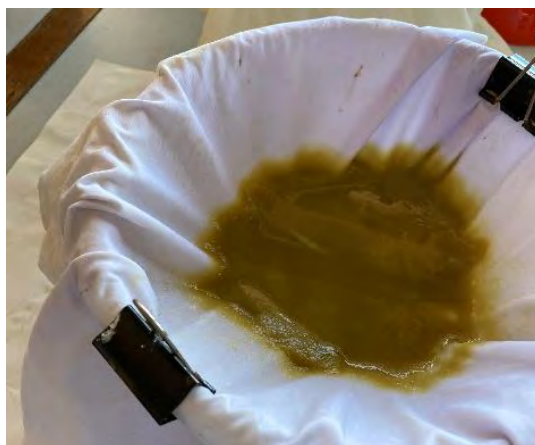
ภาพที่ 3-10 เยื่อที่ผ่านการฟอก กรองสารละลายออก และถูกชะล้างด้วยน้ำกลั่น
