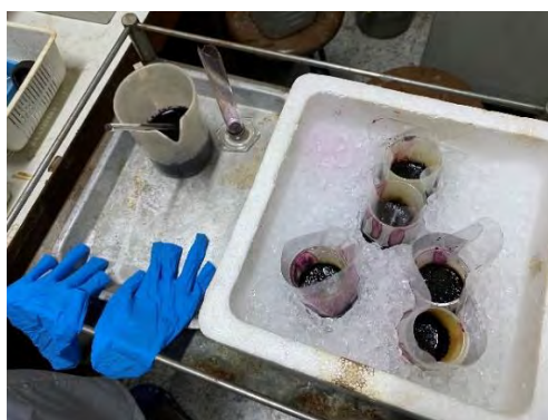
ภาพที่ 3-2 เติมสารละลาย combined permanganate ลงใน crucible ที่มีตัวอย่างบรรจุอยู่
