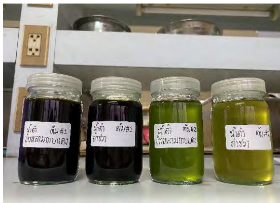
ภาพที่ 3-8 ตัวอย่างการเก็บสารละลายต่างที่ผ่านการต้มเยื่อในแต่ละรอบ
