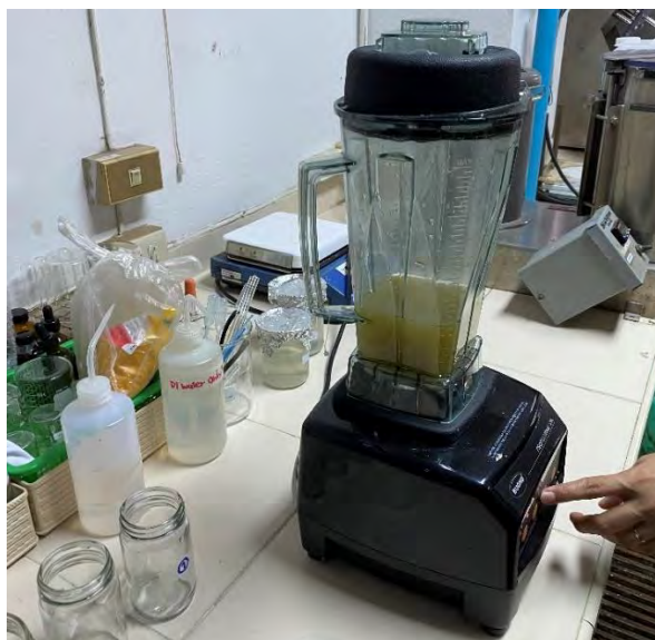
ภาพที่ 3-11 ปั่นเยื่อกับน้ำด้วยเครื่องปั่นความเร็วรอบสูง
