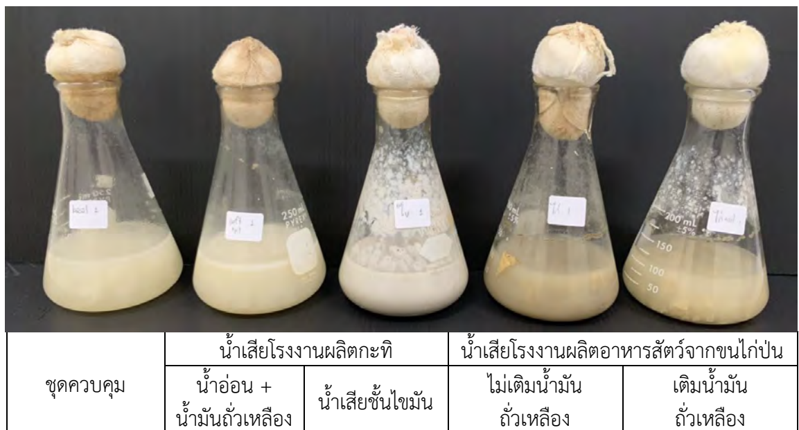
รูปที่ 3.8 การผลิตสารลดแรงตึงผิวชีวภาพด้วยน้ำเสียจากโรงงานผลิตกะทิ และโรงงานผลิตอาหารสัตว์จากขนไก่ปน
