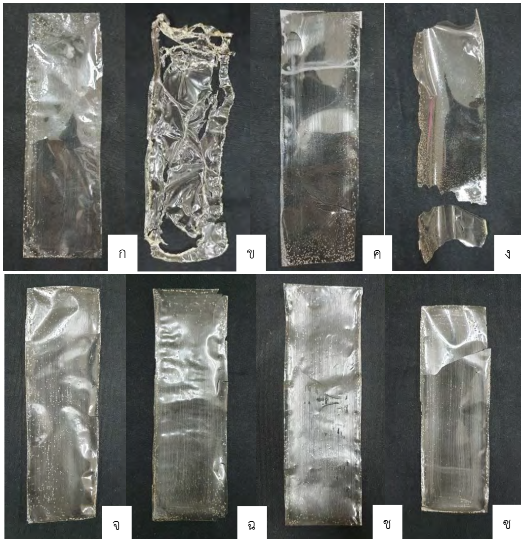
รูปที่ 12 ลักษณะของฟิล์มพอลิเอทิลีนที่ความเข้มข้น 3 4 และ 5% (น้ำหนักต่อปริมาตร) ความเข้มข้น 3% (น้ำหนักต่อปริมาตร) (ก) ความเข้มข้น 3% ผสมกับกลีเซอรอล 0.5% (โดยปริมาตร) (ข) ความเข้มข้น 5% (น้ำหนักต่อปริมาตร) (ค) ความเข้มข้น 5% ผสมกับกลีเซอรอล 0.5% (โดยปริมาตร) (ง) ความเข้มข้น 4% (น้ำหนักต่อปริมาตร) (จ) ความเข้มข้น 4% ผสมกับกลีเซอรอล 0.1% (โดยปริมาตร) (ฉ) ความเข้มข้น 4% ผสมกับกลีเซอรอล 0.5% (โดยปริมาตร) (ช) ความเข้มข้น 4% ผสมกับกลีเซอรอล 1.0% (โดยปริมาตร) (ซ)
