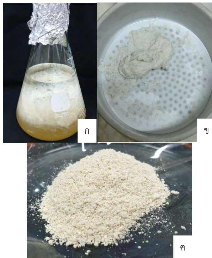
รูปที่ 11 พูลลูแลน ตะกอนพูลลูแลนเมื่อผสม 95% เอทานอลลงในส่วนของเหลวใส (ก) การใช้กระดาษกรองแยกตะกอนพูลลูแลนด้วยเครื่องดูดสุญญากาศ (ข) ผงพูลลูแลนที่ผลิตได้ (ค)
