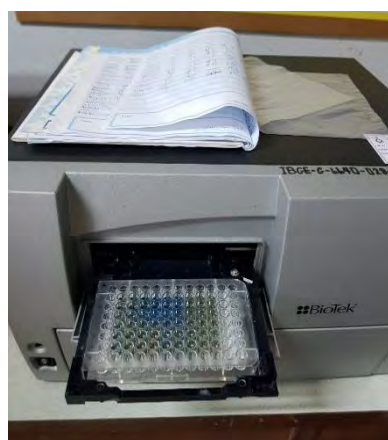
รูปที่ 3.2 เครื่อง Incubator และอุปกรณ์สำหรับวัดค่าการดูดกลืนแสง
