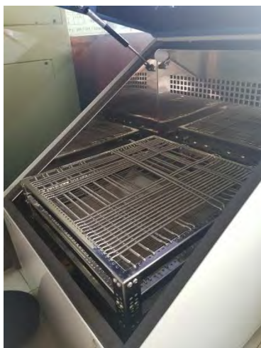
รูปที่ 3.2 เครื่อง Incubator และอุปกรณ์สำหรับวัดค่าการดูดกลืนแสง
