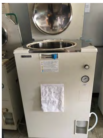
รูปที่ 3.1 เครื่อง Autoclave ยี่ห้อ HiraYama รุ่น HVA-110
