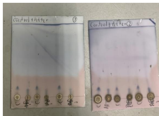
รูปที่ 3.9 แผ่น TLC ของสารตัวอย่างกิมจิ เปรียบเทียบ Control, After1, After2 และ After3 ความต่างศักย์ 9 V เป็นเวลา 5 นาที
