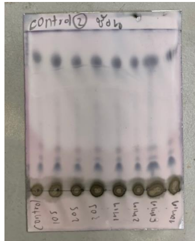
รูปที่ 3.6 แผ่น TLC Control ที่ใช้ซ้อนในการช็อต จับเวลาทุกๆ 10วินาที, 20วินาที, 30วินาที, 1 นาที, 2นาที, 5นาที และ 10นาที
