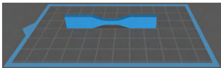
รูปที่ 4. 6 ทิศทางการพิมพ์ชิ้นงานดัมเบลครั้งที่ 1 บนโปรแกรม ChiTuBox
