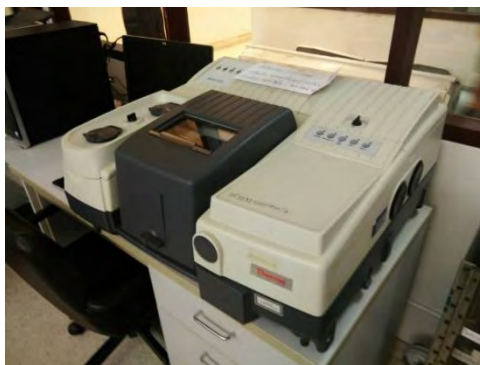
รูปที่ 3. 2 เครื่องฟูเรียร์ทรานสฟอร์มอินฟราเรดสเปกโทรสโกปี (FT-IR) รุ่น Nicolet 6700
