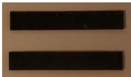
รูปที่ 4. 24 ชิ้นงานทดสอบแรงกระแทก PMMA /Graphene 0.1 phr ครั้งที่ 3
