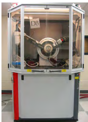
รูปที่ 3. 3 เครื่องเอกซเรย์ดิฟแฟรกชัน (XRD) รุ่น D8 Advance
