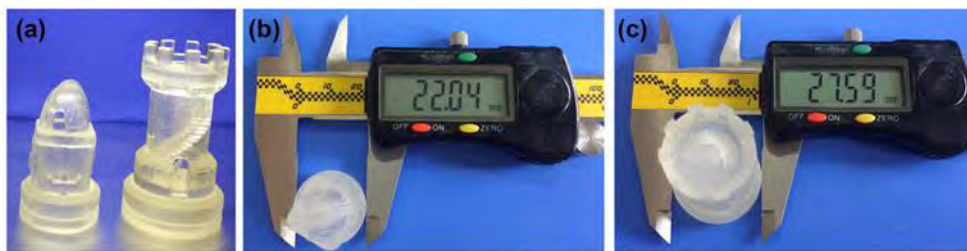
รูปที่ 2. 14 วัดชิ้นงานหลังพิมพ์ทันทีเทียบกับกับชิ้นงานที่คงรูปอย่างสมบูรณ์โดยใช้เวอร์เนีย [14]
