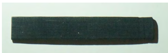
รูปที่ 4. 30 ชิ้นงานทดสอบแรงกระแทก PMMA/graphene 0.5 phr ครั้ง 3
