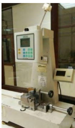
รูปที่ 3.8 เครื่องทดสอบสมบัติด้านความทนแรงกระแทก รุ่น GT-7045-MDH
