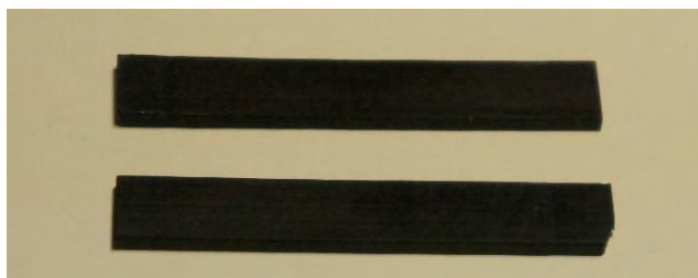
รูปที่ 4. 20 ชิ้นงานทดสอบแรงกระแทก MMA prepolymer/Graphene 0.1 phr ครั้งที่ 1
