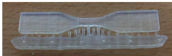
รูปที่ 4. 2 ชิ้นงานดัมเบล โดยเครื่อง Form2 ระบบ SLA
