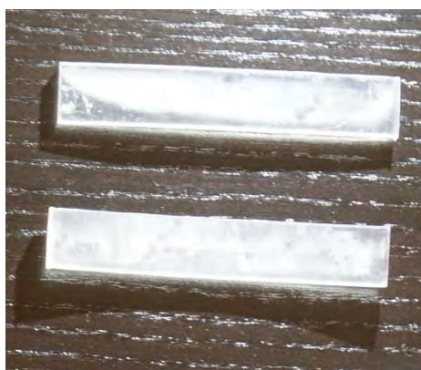
รูปที่ 4.17 ชิ้นงานทดสอบแรงกระแทกในทิศทางด้านยาวตามแกน Y
