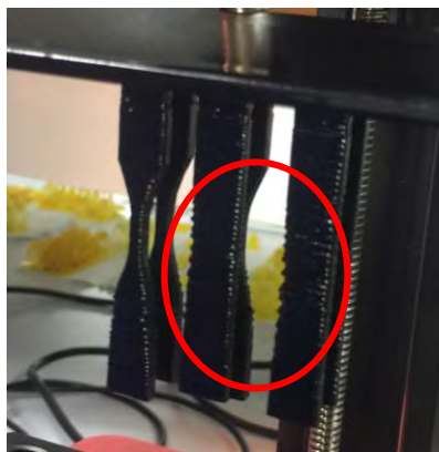
รูปที่ 4.25 เครื่องพิมพ์ชั้นงาน PMMA/graphene 0.5 phr
