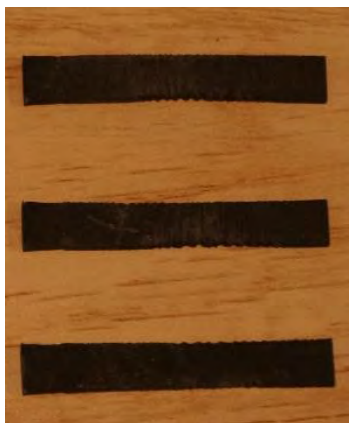
รูปที่ 4. 27 ชิ้นงานทดสอบแรงกระแทก PMMA/graphene 0.5 phr ครั้ง 1
