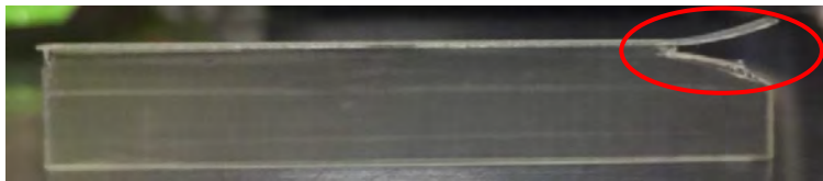
รูปที่ 4. 9 ชิ้นงานทดสอบแรงกระแทกครั้งที่ 1 เครื่อง Elegoo ระบบ DLP
