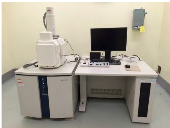
รูปที่ 3. 11 กล้องจุลทรรศน์อิเล็กตรอนแบบส่องกราด (SEM) รุ่น SU3500
