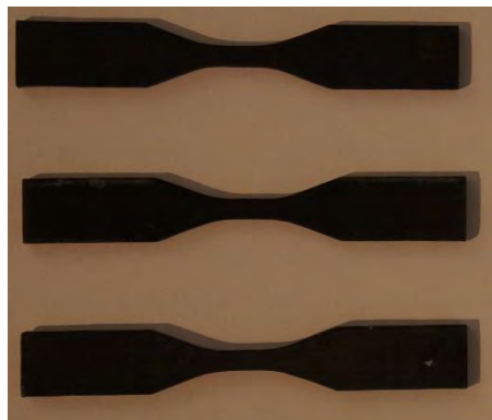
รูปที่ 4. 23 ชิ้นงานดัมเบล PMMA/graphene 0.1 phr ครั้งที่ 3
