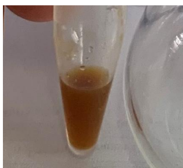
ภาพที่ 3.9 ภาพสารละลายสีน้ำตาล ของการทำปฏิกิริยาระหว่าง Fe(III) และ N 1 -hydroxy- N 6 -phenylhexanediamide
