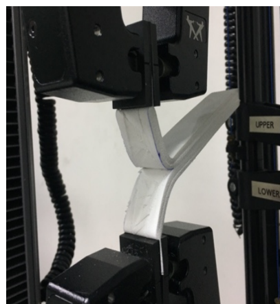
ภาพที่ 2.9 ลักษณะการใส่ชิ้นงาน ทดสอบ split tear
