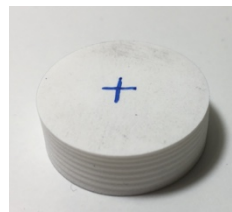
ภาพที่ 2.3 ชิ้นงานทดสอบสมบัติการยุบตัวเนื่องจากแรงอัด (compression set)
