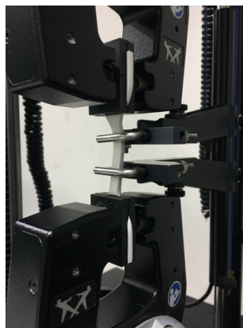
ภาพที่ 2.6 ลักษณะการใส่ชิ้นงานทดสอบ tensile strength
