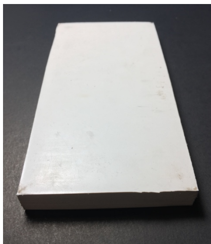
ภาพที่ 4.1 โฟมคอมพอสิตของอีวีเอ-พอลิเอทิลีนออกทีน-ยางธรรมชาติที่ขึ้นรูปแล้ว
