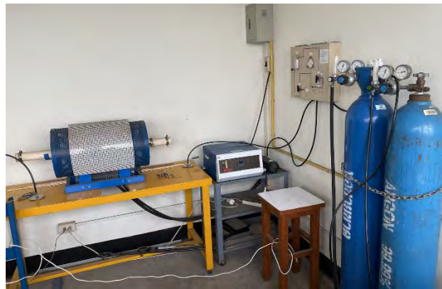
รูปที่ 3.4 ระบบเตาหลอมที่ใช้แก๊สอาร์กอน
