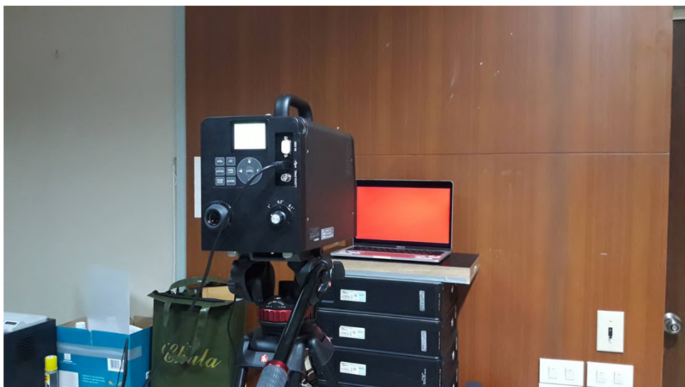
ภาพที่ 3.9 ตำแหน่งการวางเครื่องคอมพิวเตอร์และเครื่องวัดสี
