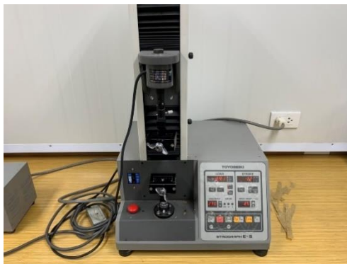
ภาพที่ 3.5 เครื่องวัดความแข็งแรงต่อแรงดึง
