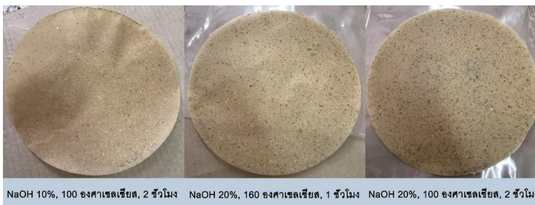
ภาพที่ ง-3 ตัวอย่างกระดาษทดสอบจากเยื่อเปลือกส้มโอที่ต้มในสภาวะต่าง ๆ
