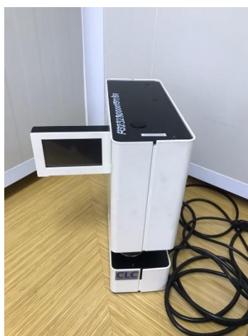
ภาพที่ 3.4 เครื่องวัดความหนา
