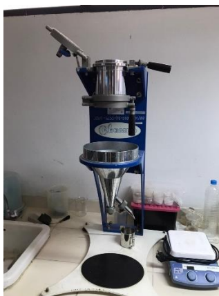
ภาพที่ 3.1 เครื่องทดสอบกระดาษใยได้
