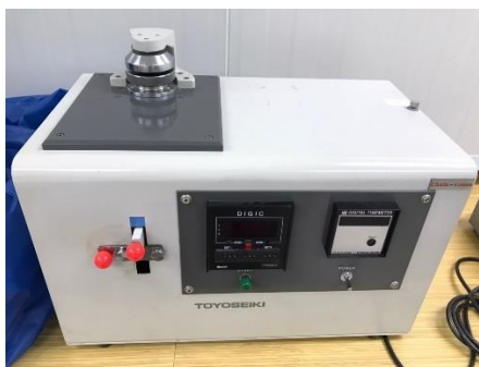
ภาพที่ 3.7 เครื่องวัดความเรียบ
