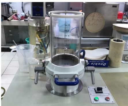
ภาพที่ 3.3 เครื่องขึ้นแผ่นกระดาษอัตโนมัติ
