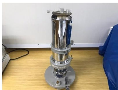
ภาพที่ 3.9 เครื่องวัดความพรุน
