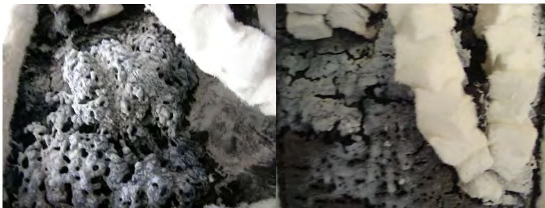
รูปที่ 4.7 แสดงชั้นคาร์บอนของอัตราส่วนในกรณีที่เป็นผงที่มีการเติมซิลิโคนออกไซด์
