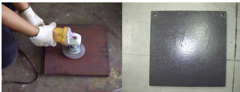
รูปที่ 3.3 รูปการเตรียมแผ่นเหล็กโดยการขัดและทาสีรองพื้น
