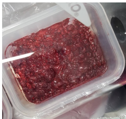
ภาพที่ 8 สารสกัดเบตาไซยานินเข้มข้นจากเปลือกแก้วมังกร หลังผ่านกระบวนการทำแห้งด้วยการแช่เยือกแข็ง
