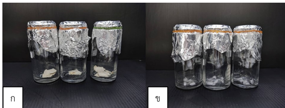
รูปที่ 2.2 การทดลองการย่อยสลายของแบคทีเรียผสมบนวัสดุรีงกระดาษเคลือบพลาสติก PBS (ก) และพลาสติกชนิด PLA (ข)
