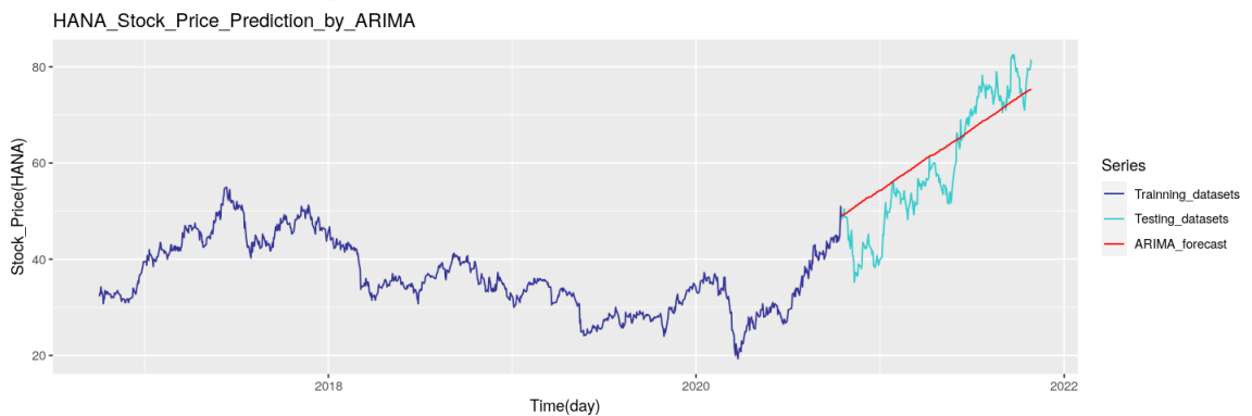
ภาพ 3.6 แสดงกราฟระหว่าง ชุดข้อมูลฝึก, ชุดข้อมูลตรวจสอบภายใต้การแบ่งข้อมูลด้วยวิธี rolling forward validation แบบ cumulative และค่าพยากรณ์ (forecast) ของราคาปิดหุ้น HANA รายวันด้วยตัวแบบ ARIMA ของรอบที่ 4
