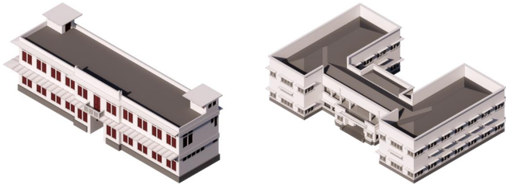
ภาพที่ 267 อาคารโรงเรียนช่างพิมพ์วัดสังเวช (ซ้าย) และอาคารเคมี จุฬาลงกรณ์มหาวิทยาลัย (ขวา) แสดงการใช้พาราเปต (parapet) กับอาคารที่มีหลังคาแบน (flat slab) และหลังคาปั้นหย่า (ที่มา: ผู้วิจัย)
