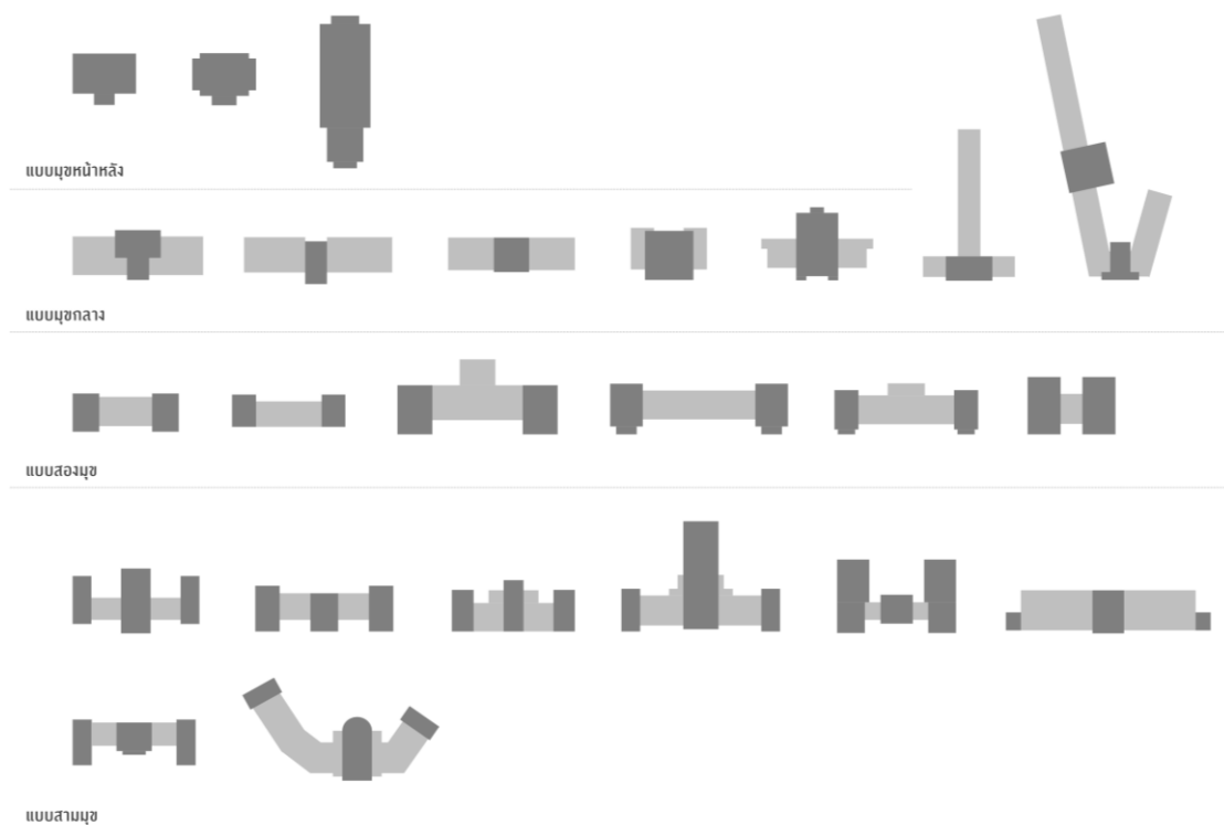
ภาพที่ 213 ผังพื้นของพระสาโรชรัตนนิมมานก์ แบ่งตามระบบมุข และปีกอาคาร ได้แก่ ผังพื้นอาคารแบบมุขเดียว ไม่มีปีกอาคาร อาคารแบบมุขเดียว มีปีกอาคาร อาคารแบบสองมุข และอาคารแบบสามมุข (ที่มา: ผู้วิจัย)
