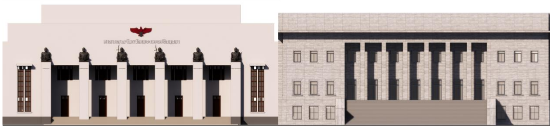
ภาพที่ 268 อาคารศาลากลางจังหวัดพระนครศรีอยุธยา (ซ้าย) และอาคารที่ทำการกระทรวงยุติธรรม (ขวา) แสดงการใช้โถงเสา ในการ ออกแบบทางเข้าอาคาร ซึ่งรับวิธีการมาจากการออกแบบพอร์ติโก (Portico) ของสถาปัตยกรรมแบบคลาสสิก (ที่มา: ผู้วิจัย)
