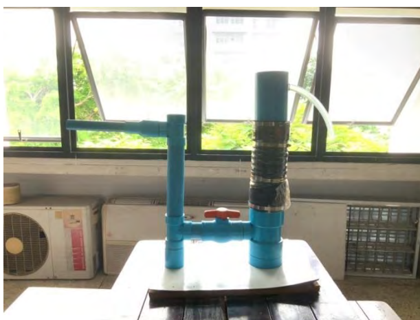
รูปที่ 3.3 อุปกรณ์ทดสอบ Water permeability
