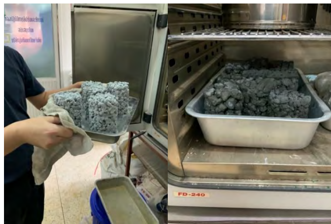
รูปที่ 3.10 นำชิ้นงานหลังจากการบ่มเข้าอบระยะเวลา 1 คืน จากนั้นแล้วเตรียมนำไปทดสอบสมบัติ
