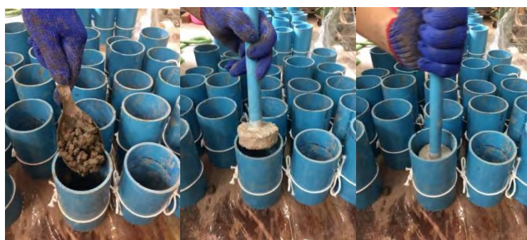
รูปที่ 3.8 ตักส่วนผสมลงไปยังแม่พิมพ์เสร็จแล้วทำการอัดส่วนผสมให้มีความแน่นเข้ากัน
