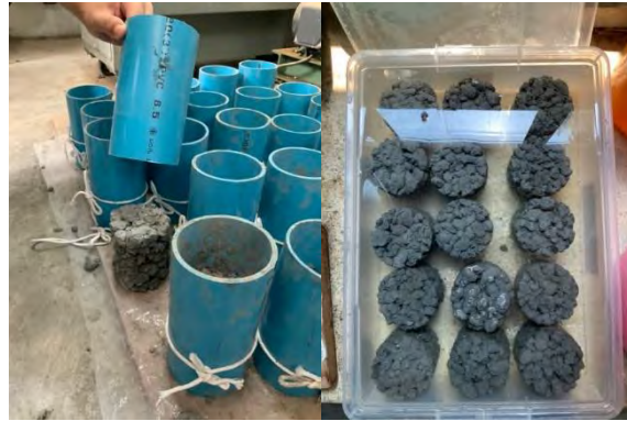
รูปที่ 3.9 แกะชิ้นงานออกจากแม่พิมพ์และนำไปแช่ในน้ำตามระยะเวลาที่กำหนด
