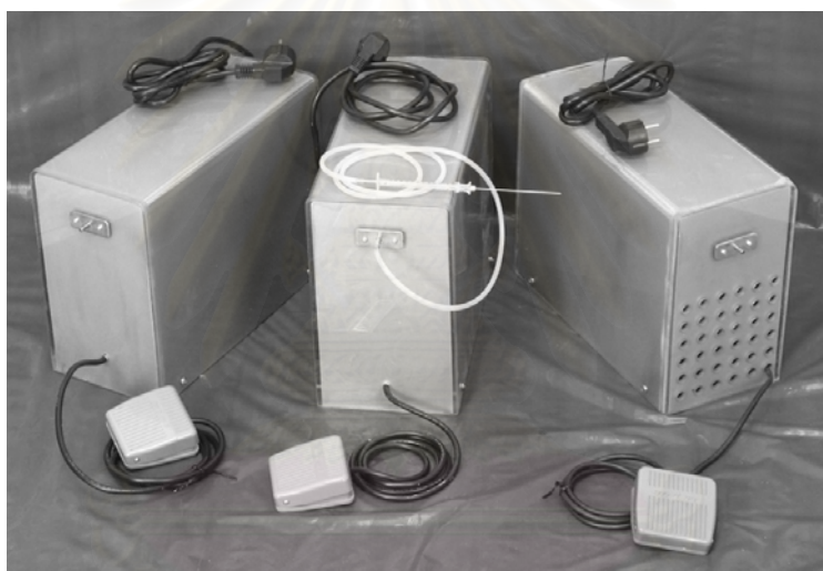
ภาพที่ 9 เครื่องดูดไฟฟ้าขนาดกลางดูดด้วยระบบโรตารี มีศักยภาพมากกว่าเครื่องเล็กที่ประกอบขึ้นก่อน 1.5 เท่า สันน้อย กินไฟน้อย และเสียงเบา เคลื่อนย้ายโดยการดัดล้อที่ฐาน มีท่อต่อดูดสูญญากาศอยู่ทางด้านหน้า รุ่นนี้สามารถติดตั้งกระบอกคักของเหลวภายในได้ปริมาณมากก้นไม่ให้ของเหลวถูกดูดเข้าไปในระบบโรตารี กล่องบรรจุประกอบขึ้นจากแผ่น อคิลิกขึ้นรูปด้วยความร้อนพ่นสีโลหะที่ด้านในของกล่อง ทดลองเจาะรูระบาย แบบต่างๆทางด้านหลัง
