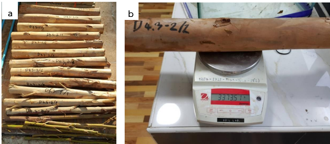
ภาพที่ 4.24 (a) แสดงลำต้นไม้ทดสอบตัดเป็นท่อน ความยาวท่อนละ 0.80 เมตรและ (b) แสดงการชั่งน้ำหนักท่อนไม้ด้วยความละเอียด 0.01 กิโลกรัม
