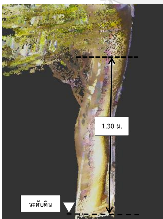
ภาพที่ 4.23 การวัดขนาดเส้นผ่านศูนย์กลางที่ความสูงเพียงอกจากพอยท์คลาวด์สามมิติ
