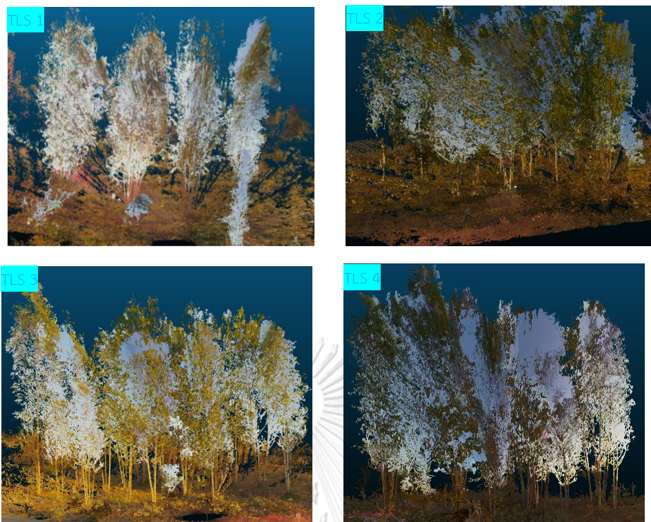
ภาพที่ 4.6 แสดงพอยท์คลาวด์จากตำแหน่งตั้งเครื่องสแกนเลเซอร์ภาคพื้นดิน ตำแหน่งที่ 1 ถึง 4
