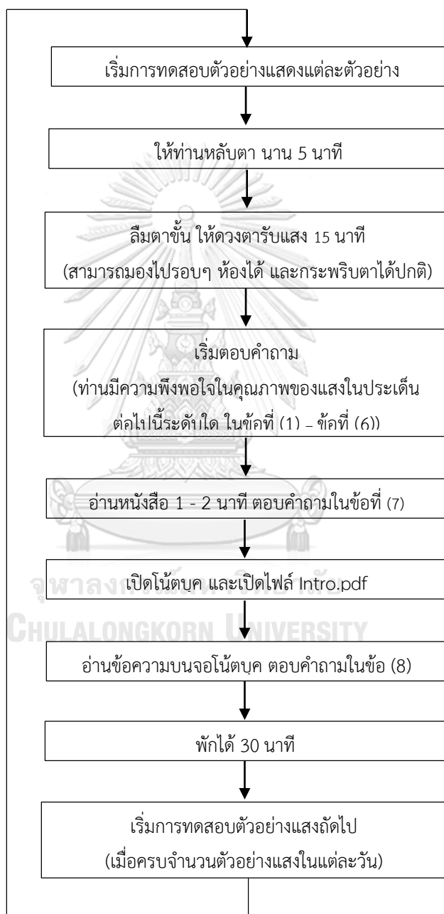
ภาพที่ 3.33 กระบวนการทดสอบตัวอย่างแสงแต่ละตัวอย่าง
