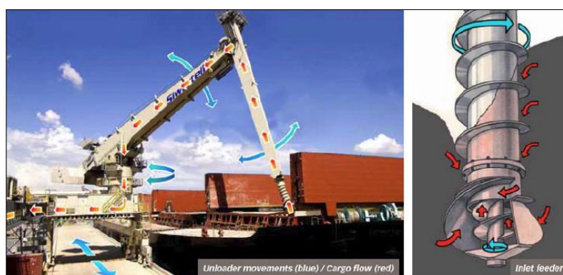
รูปที่ 3.4-3 อุปกรณ์ลำเลียงถ่านหินจากเรือบรรทุก
