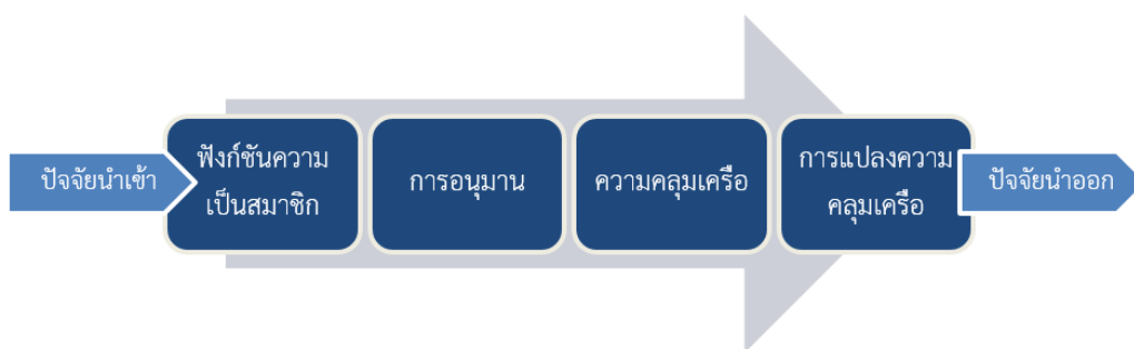
รูปที่ 2.2-3 ขั้นตอนการประมวลผลแบบตรรกะแบบคลุมเครือ
