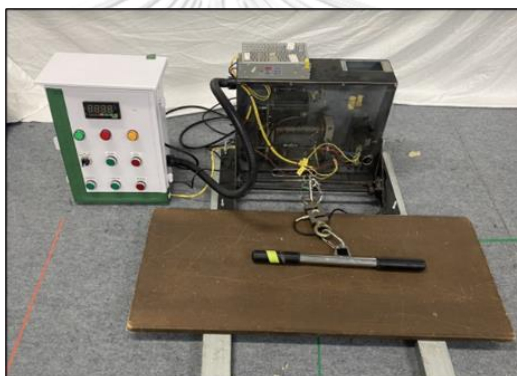
รูปที่ 3.1 เครื่องวัดกำลังสถิตและพลวัตแฝง
