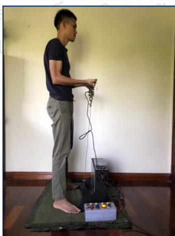
รูปที่ 3.18 ท่าการวัดกำลังสถิตกล้ามเนื้อแขน
