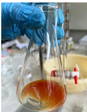
รูปที่ 63 ไทเทรตด้วยสารละลายซิลเวอร์ไนเตรต ( \text{AgNO}_3 ) จนเปลี่ยนเป็นตะกอนสีส้ม
