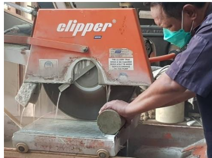
รูปที่ 53 ตัดมอร์ตาร์ที่ความลึกต่างๆ
