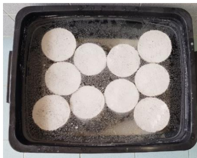
รูปที่ 50 นำมอร์ตาร์บ่มในน้ำปูนขาวอิมตัว
