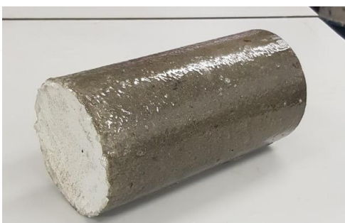
รูปที่ 51 นำมอร์ตาร์ไปเคลือบผิวด้วยอีพอกซี โดยจะให้มิด้านหน้าวงกลม 1 หน้าที่ไม่เคลือบผิว จากนั้นวางทิ้งไว้เป็นเวลา 24 ชั่วโมง ให้อีพอกซีแห้ง
