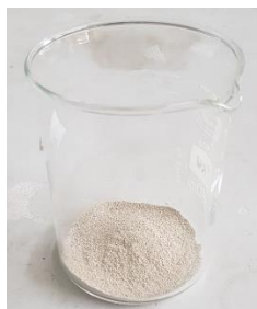
รูปที่ 56 ชั่งผงมอร์ตาร์ปริมาณ 10 กรัม ใส่ลงในปิกเกอร์
