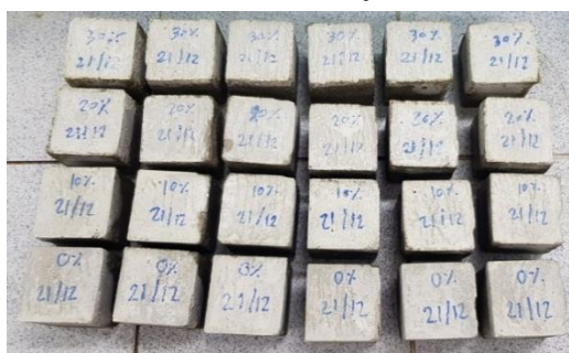
รูปที่ 44 นำมอร์ตาร์ขึ้นมาจากน้ำปูนขาว แล้วเซ็ดตัวอย่างให้แห้ง
