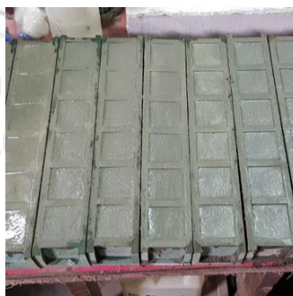
รูปที่ 42 ใช้เกรียงปาดผิวหน้าของมอร์ตาร์ให้เรียบ
