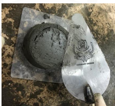
รูปที่ 30 ปาดซีเมนต์เพสต์ส่วนเกินออกจากแบบ G โดยใช้เกรียงปาดเพียงครั้งเดียว
