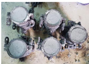
รูปที่ 49 ใช้ไม้เคาะแบบหล่อด้านนอกเบาๆจำนวน 10-15 ครั้ง จากนั้นใช้เกรียงปาดผิวหน้าให้เรียบ
