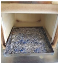
รูปที่ 20 แผงพลังงานแสงอาทิตย์ที่ผ่านการอบ
