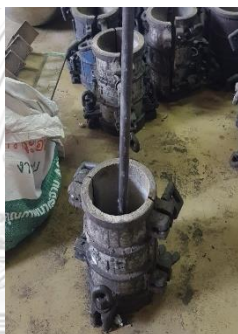
รูปที่ 48 นำมอร์ตาร์ใส่แบบหล่อ โดยแบ่งการเทเป็น 2 ชั้นเท่าๆกัน โดยใช้เหล็กกระทุ้งจำนวน 25 ครั้งต่อชั้น
