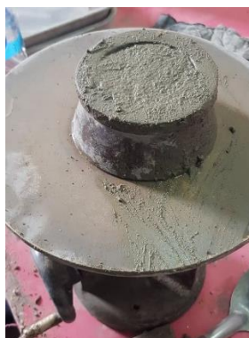
รูปที่ 37 ตักมอร์ตาร์ใส่แบบและปาดมอร์ตาร์ส่วนเกินออกทิ้ง
