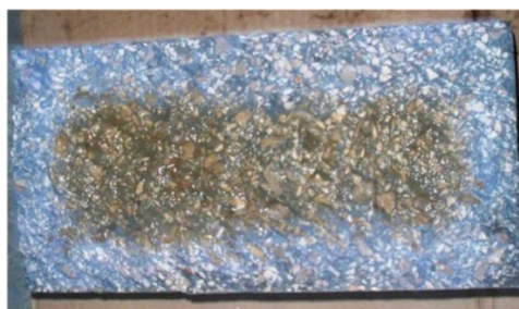
รูปที่ 14 ผลของการทดสอบความต้านทานของการแทรกซึมคลอไรด์ด้วยวิธีการฉีดสี ที่มา: (Paiva และคณะ, 2016)
