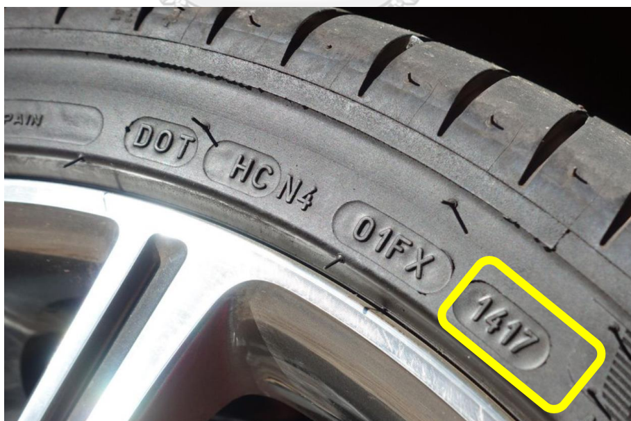
รูปที่ 3-7 ตัวอย่างสัญลักษณ์บนแก้มยาง และสัญลักษณ์บอกสัปดาห์และปีที่ผลิต
