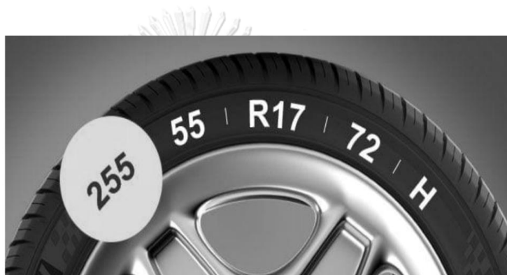
รูปที่ 4-3 คำอธิบายขนาดทางกายภาพบนแก้มยาง [27]
