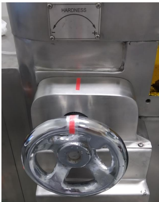
รูปที่ 3-8 วงล้อปรับแรงตอก
