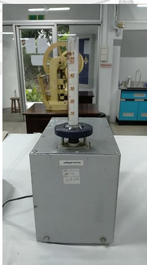
รูปที่ 3-3 เครื่องเคาะสำหรับหาค่าความหนาแน่นภายหลังการเคาะ และกระบอกตวง
