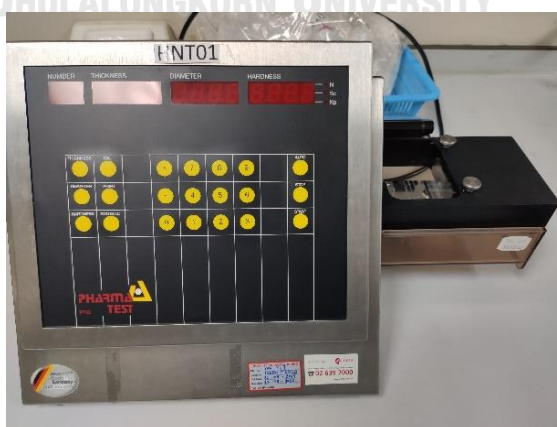
รูปที่ 3-11 เครื่องวัดความแข็ง ความหนา และขนาดเส้นผ่านศูนย์กลางเม็ดยา
