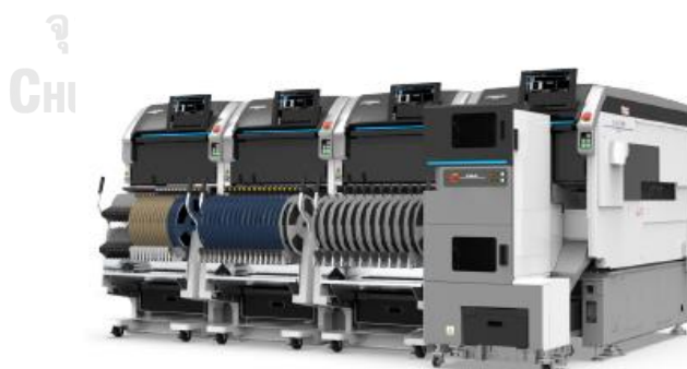
รูปที่ 1-15 เครื่องวางอุปกรณ์อิเล็กทรอนิกส์ (Moulder) (ที่มา: https://www.fuji.co.jp/en/items/rs_list/ )
