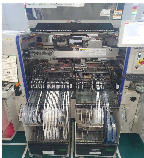
รูปที่ 1-20 ตัวอย่างการติดตั้งรถขนอุปกรณ์อิเล็กทรอนิกส์ลงบนเครื่องวางอุปกรณ์
