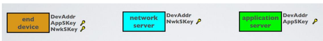
ภาพที่ 14 แสดง Key ที่แต่ละองค์ประกอบถูกตั้งค่าไว้ก่อนการใช้งาน เพื่อให้สามารถใช้งานเครือข่ายสื่อสาร LoRaWAN ด้วยวิธี OTAA [45]
