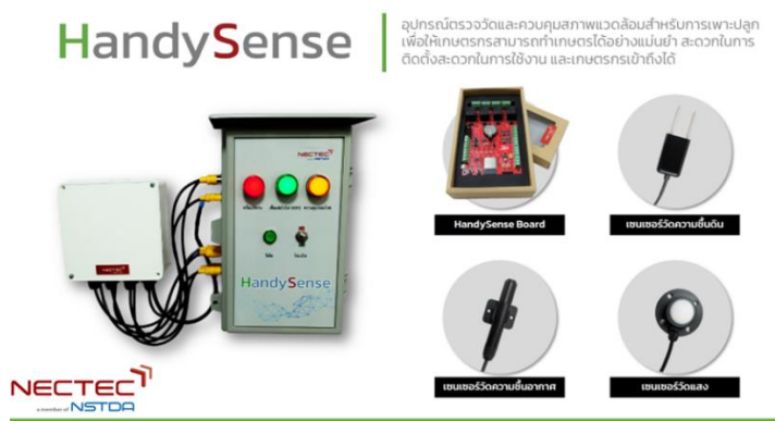
ภาพที่ 5 อุปกรณ์ตรวจวัดและควบคุมสภาพแวดล้อมสำหรับการเพาะปลูก HandySense
