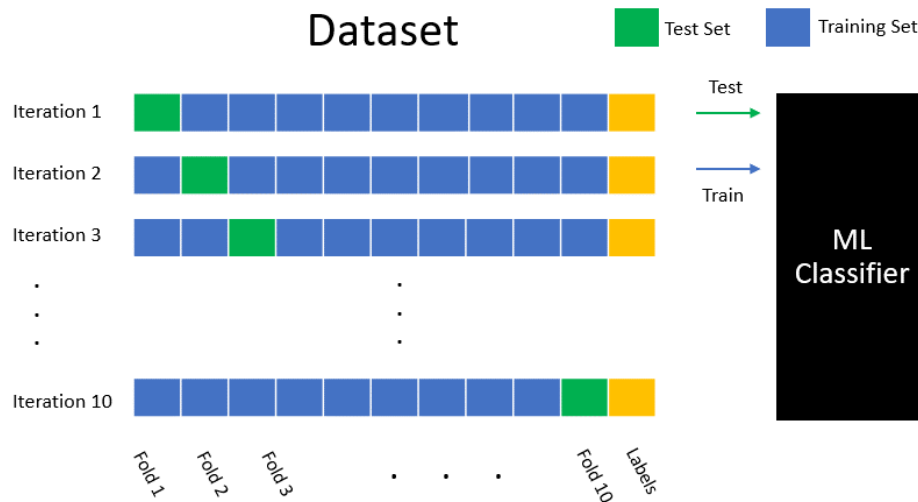
ภาพที่ 10 ภาพแสดงการแบ่งข้อมูลด้วย 10-Fold Cross Validation
