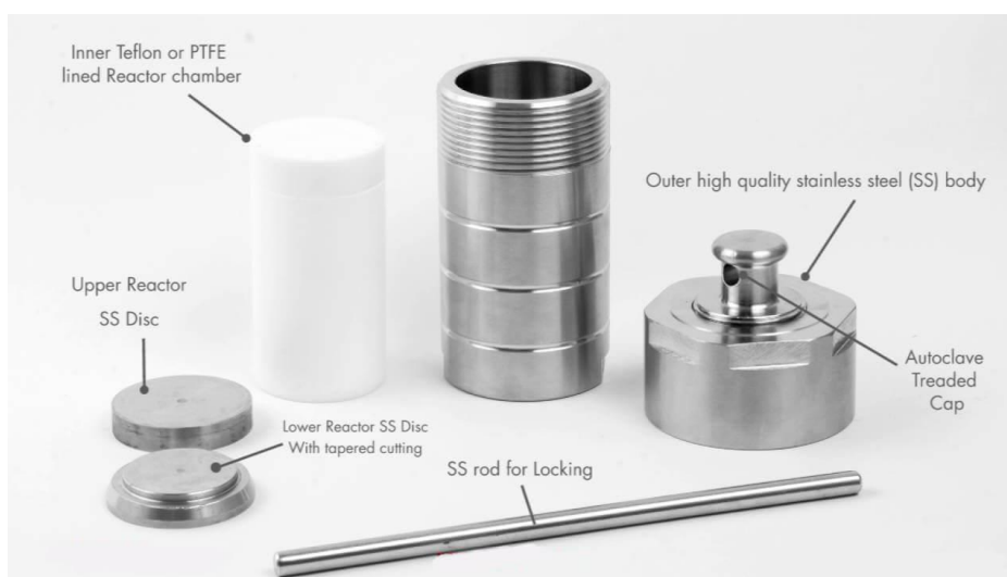
รูปที่ 2.6 อุปกรณ์ในกระบวนการไฮโดรเทอร์มัล [19]
