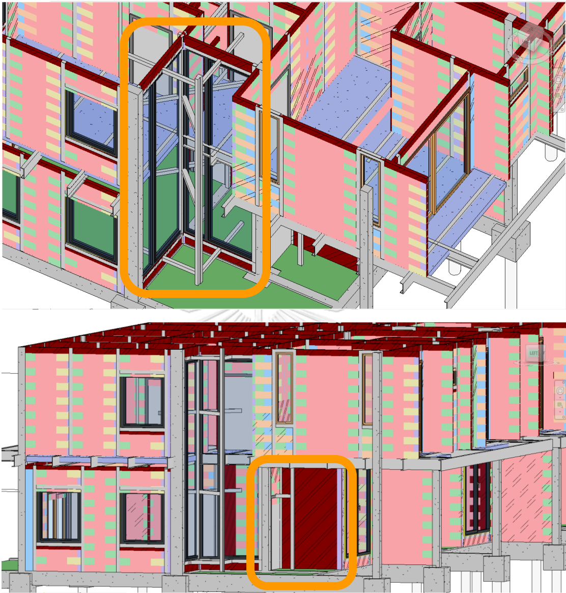
รูปที่ 5.12 ชั้นส่วนที่ถูกสร้างขึ้นเกินเนื่องจากการซ้อนกันของหน้าต่างและอิฐไม่ถูกสร้างในผนังนั้น
