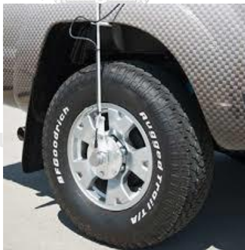
รูปที่ 3-7 แสดงภาพ DMI ที่ติดตั้งอยู่ที่ล้อของยานพาหนะ รูปจาก Topcon (2021)
