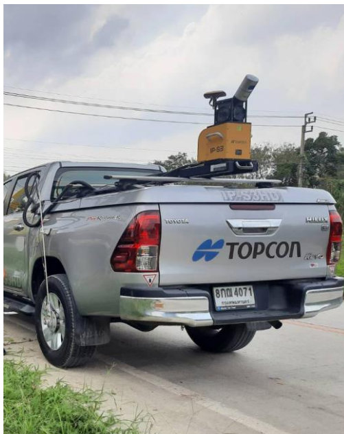
รูปที่ 3-8 แสดงยานพาหนะที่ติดตั้งอุปกรณ์ IP-S3 เก็บข้อมูลสภาพแวดล้อมของถนน
