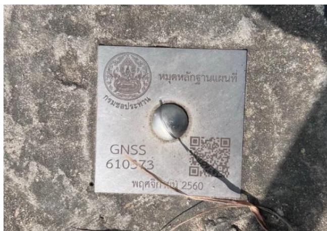
รูปที่ 3-3 แสดงหมุดหลักฐานอ้างอิง GNSS 610373 ของกรมชลประทาน
