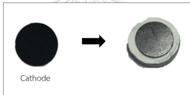
รูปที่ 3.10 ลักษณะ Cathode และภาพหลังจากประกอบแล้วเสร็จ
