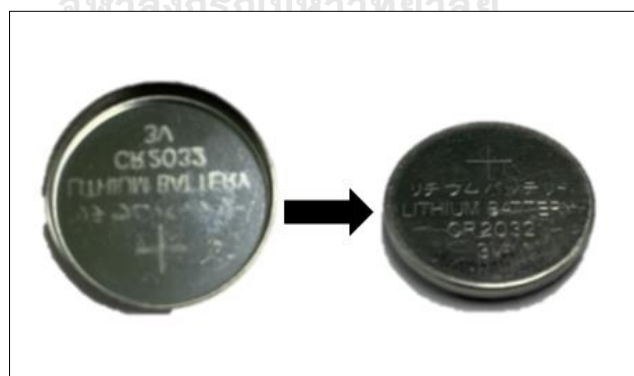
รูปที่ 3.11 ลักษณะ Positive electrode case และภาพหลังจากประกอบแล้วเสร็จ
