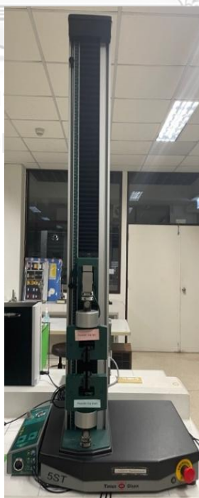
รูปที่ 3.4 เครื่องทดสอบสมบัติเชิงกลอเนกประสงค์ (Universal testing machine, UTM)
