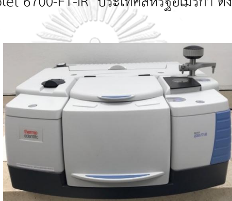
รูปที่ 3.1 เครื่องฟูเรียร์ทรานสฟอร์มอินฟราเรดสเปกโตรมิเตอร์
