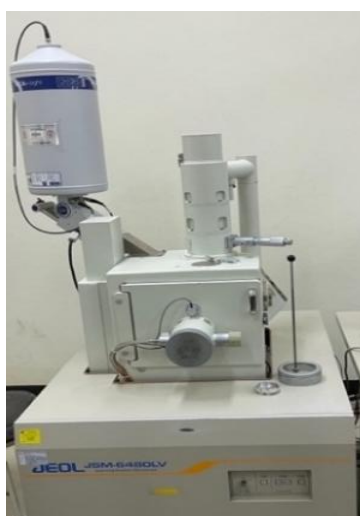
รูปที่ 3.2 กล้องจุลทรรศน์อิเล็กตรอนแบบส่องกราด
