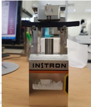
รูปที่ 3.13 การเตรียมตัวอย่างชิ้นงานของไส้กรองน้ำคาร์บอนจากถ่านไม้ไฟในการวิเคราะห์ความแข็งแรงของชิ้นงาน
