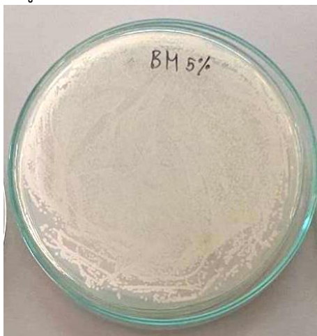
รูปที่ 4.48 ผลการทดสอบการเกิดรัศมีการต้านแบคทีเรีย (Halo test) ของสารโพโตคะตะลิสต์ \text{SiO}_2/\text{g-C}_3\text{N}_4 ที่เตรียมด้วยวิธีที่ 1 โดยเติมปริมาณซิลิการ้อยละ 5 โดยน้ำหนัก
