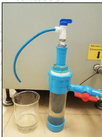
รูปที่ 4.49 การทดสอบอัตราการไหลของน้ำที่ผ่านไส้กรองน้ำคาร์บอนจากถ่านไม้ไผ่เคลือบด้วย ซิลิคอนคาร์ไบด์และโฟโตคะตะลิสต์ซิลิกา/กราฟิติกคาร์บอนไนไตรด์
