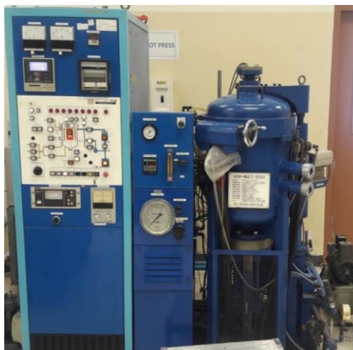
รูปที่ 3.6 เตาควบคุมบรรยากาศสุญญากาศ High-Multi 5000 FV PHP-R-5FRET-25
