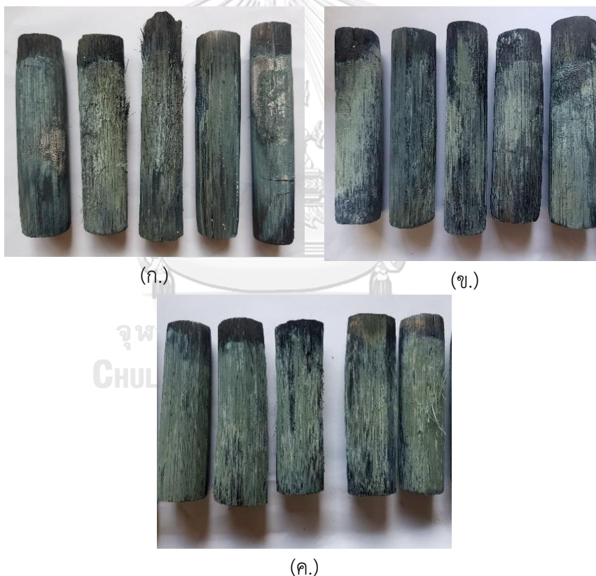
รูปที่ 4.17 ไส้กรองน้ำคาร์บอนจากถ่านไม้ไผ่ที่ถูกเคลือบด้วยซิลิคอนคาร์ไบด์หลังกระบวนการคาร์โบเทอร์มัลรีดักชันที่อุณหภูมิ 1400 องศาเซลเซียส คงที่ (ก.) 1 ชั่วโมง (ข.) 2 ชั่วโมง และ (ค.) 3 ชั่วโมง
