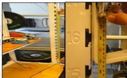
รูปภาพที่ 9 แสดงการวัดระยะระหว่างหมายเลข 1 และ 16 ได้ 120 เซนติเมตร
