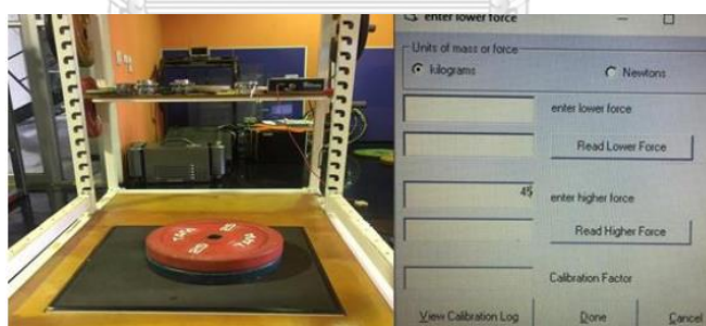
รูปภาพที่ 7 แสดงการวางแผ่นน้ำหนักลงบนแผ่นรับแรงกระแทก
