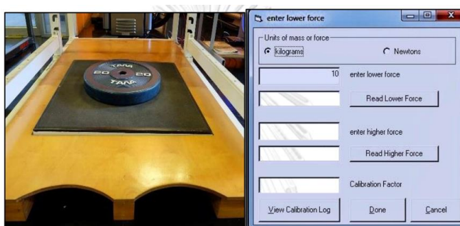
รูปภาพที่ 6 แสดงการวางแผ่นน้ำหนักลงบนแผ่นรับแรงกระแทก
