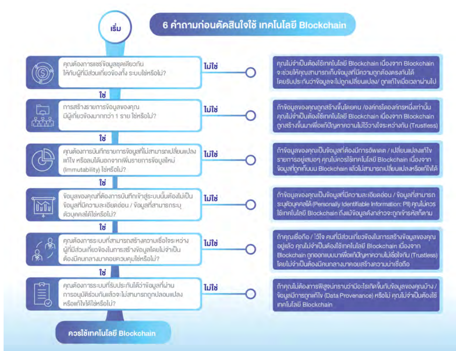
รูปที่ 14 กระบวนการตัดสินใจก่อนการนำเทคโนโลยี Blockchain มาใช้งาน (ที่มา: การใช้เทคโนโลยีบล็อกเชนสำหรับภาครัฐ)
