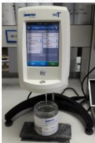
รูปที่ 14 เครื่อง Brook field สำหรับวัดค่าความหนืด
