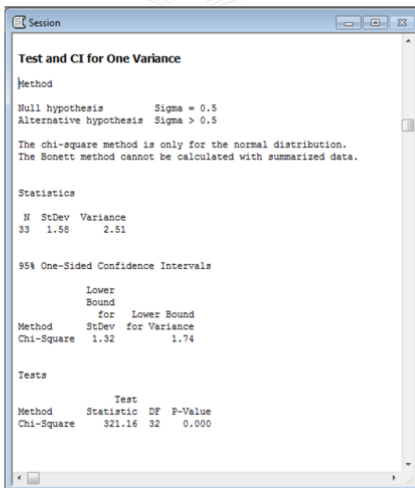
รูปที่ 22 ผลการทดสอบความแปรปรวนด้วยโปรแกรม MINITAB ของผลการวัดค่าความหนืดตามการเปลี่ยนจุดวัดตามตำแหน่งแนวแกนตั้ง
