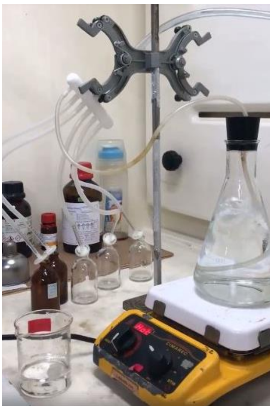
รูปที่ 34 การเตรียมการทดลองภายใต้สภาวะที่ไม่มีออกซิเจน
