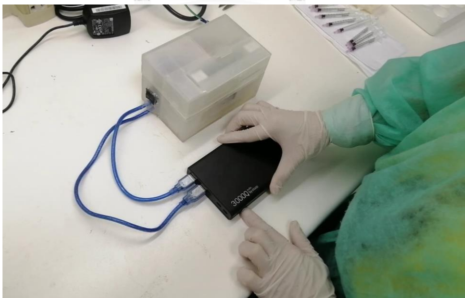
รูปที่ 4.39 การต่อสายไฟของอุปกรณ์ต้นแบบเข้ากับแบตเตอรี่สำรอง
