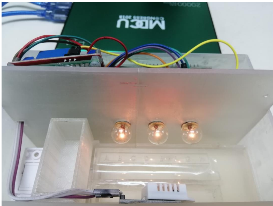
รูปที่ 4.16 หลอดไฟที่ส่องสว่างจากการใช้แบตเตอรี่สำรองเป็นแหล่งพลังงานให้กับอุปกรณ์ต้นแบบ
