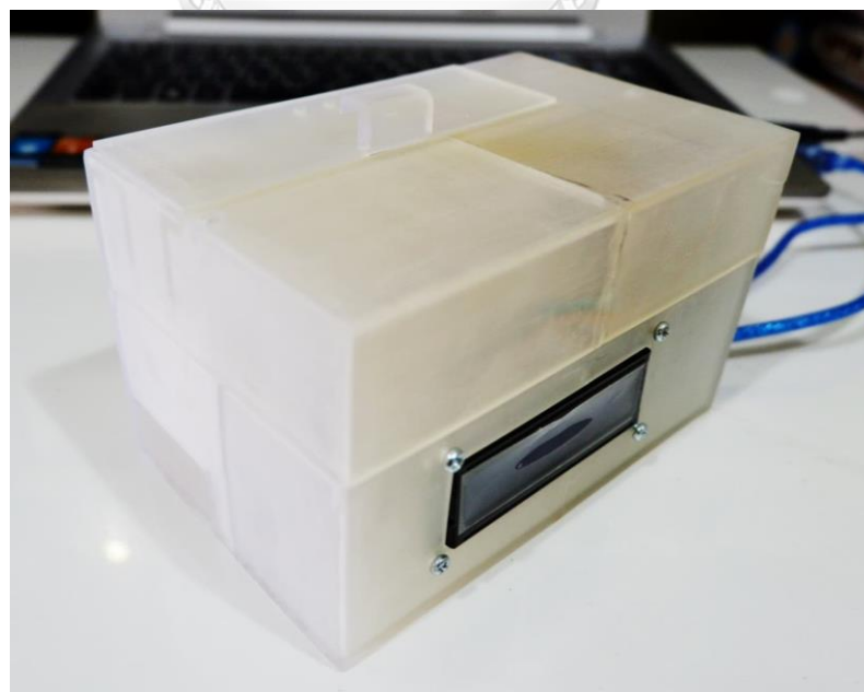
รูปที่ 4.28 อุปกรณ์ต้นแบบจากการขึ้นรูปด้วยเทคโนโลยีสามมิติโดยวัสดุเรซิน
