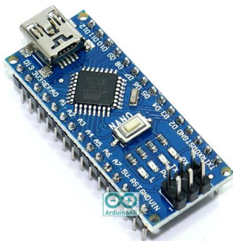
รูปที่ 3.2 บอร์ดไมโครคอนโทรลเลอร์ Arduino Nano 3.0 [24]
