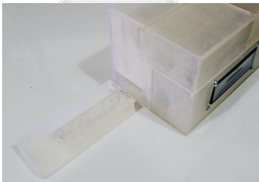
รูปที่ 4.36 ส่วนใส่หลุมทดสอบที่ออกมาจากอุปกรณ์ต้นแบบพร้อมสำหรับการนำไปล้างหลุมทดสอบตามขั้นตอน
