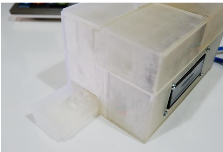
รูปที่ 4.35 ส่วนใส่หลุมทดสอบที่ออกมาจากอุปกรณ์ต้นแบบจากกลไกการนำเข้า-ออก
