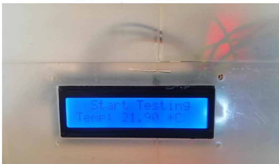
รูปที่ 4.41 หน้าจอแสดงผลเมื่อกดสวิตช์เกิดเพื่อเริ่มการใช้งานของอุปกรณ์ต้นแบบ
