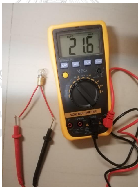
รูปที่ 3.7 วัดค่าความต้านทานทางไฟฟ้าของหลอดไฟขนาด 4.8 โวลต์ ด้วยมัลติมิเตอร์
