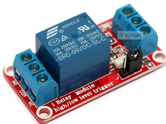
รูปที่ 3.5 บอร์ดรีเลย์ Relay 5 โวลต์ 1 Channel Isolation High And Low Trigger [24]
