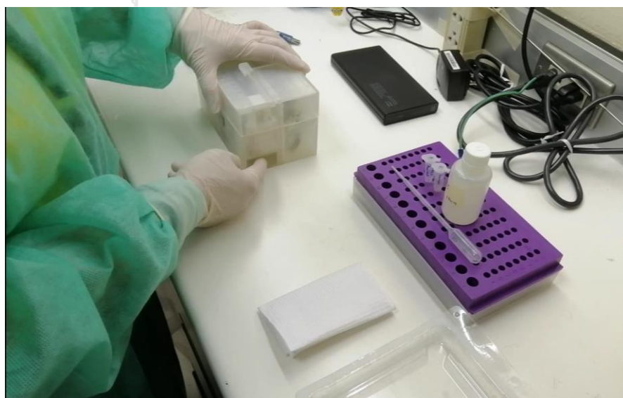
รูปที่ 4.44 การกดส่วนใส่หลุมทดสอบเพื่อให้สามารถนำออกมาล้างหลุมทดสอบ
