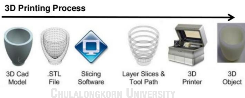
รูปที่ 2.12 กระบวนการทำงานของเทคนิคการพิมพ์แบบสามมิติ [10]
