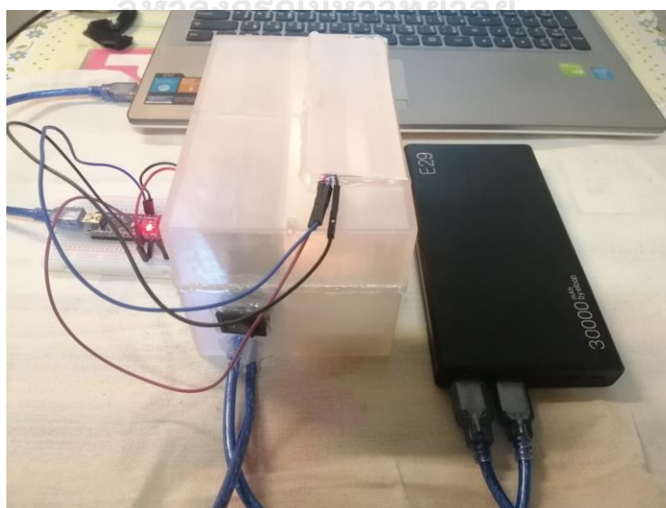
รูปที่ 4.13 การทดสอบการใช้งานอุปกรณ์ต้นแบบด้วยการใช้แบตเตอรี่สำรองเป็นแหล่งพลังงาน
