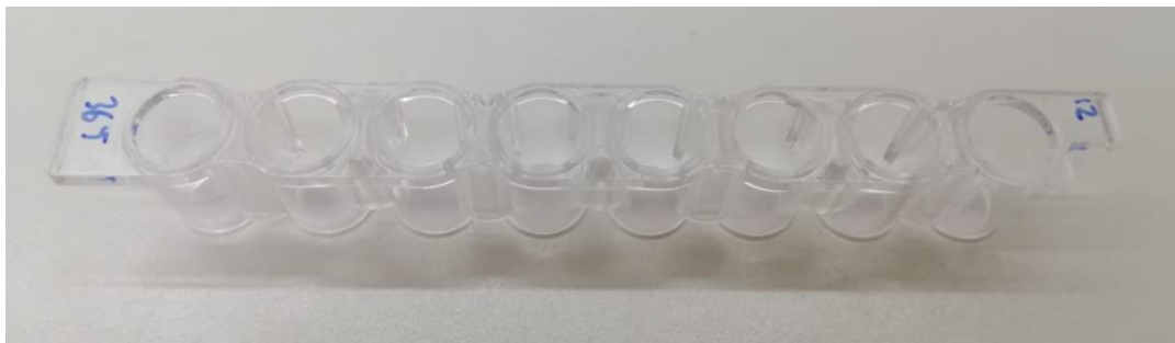
รูปที่ 4.4 หลุมทดสอบที่เคลือบสารและยาที่ความเข้มข้นต่ำและสูงของยาแต่ละชนิดที่พร้อมใส่ในอุปกรณ์ต้นแบบก่อนเริ่มใช้งาน
