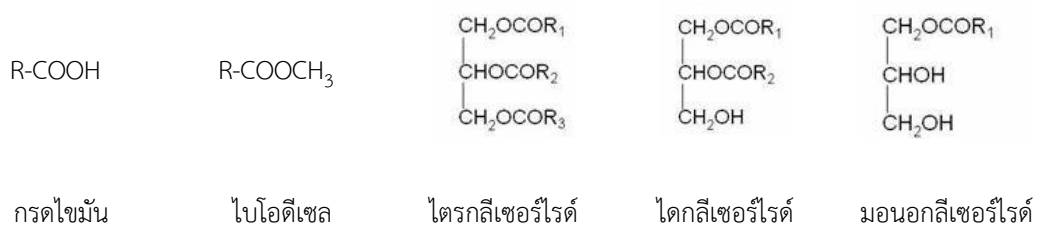
รูปที่ 33 โมเลกุลของกรดไขมัน ไบโอดีเซล ไตรกลีเซอไรด์ ไดกลีเซอไรด์ และมอนอกลิเซอไรด์
