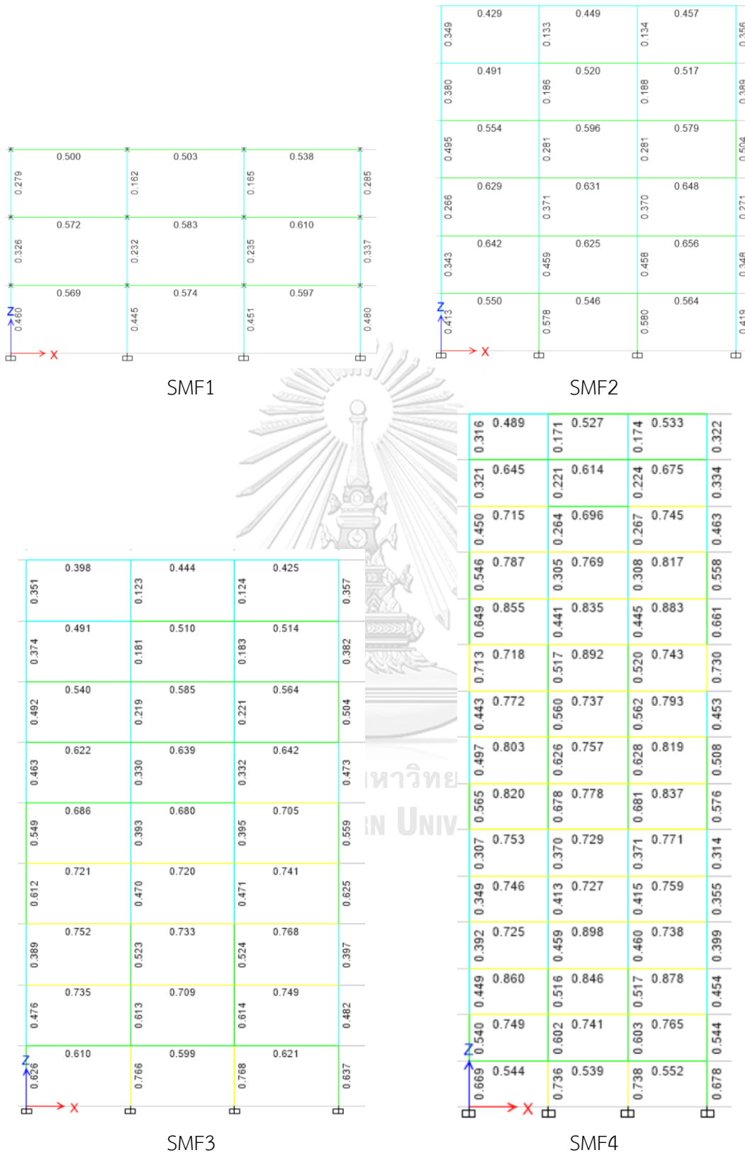
รูปที่ ง.2 อัตราส่วนระหว่างแรงที่ต้องต้านทานกับกำลังต้านทาน (DCR) ของอาคารโครงสร้างแรงดึงเหล็กที่มีความเหนียวพิเศษ (SMF)
