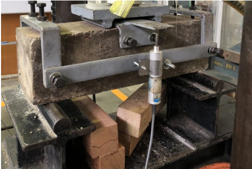
รูปที่ 39 การทดสอบกำลังรับแรงดัดของคอนกรีต
