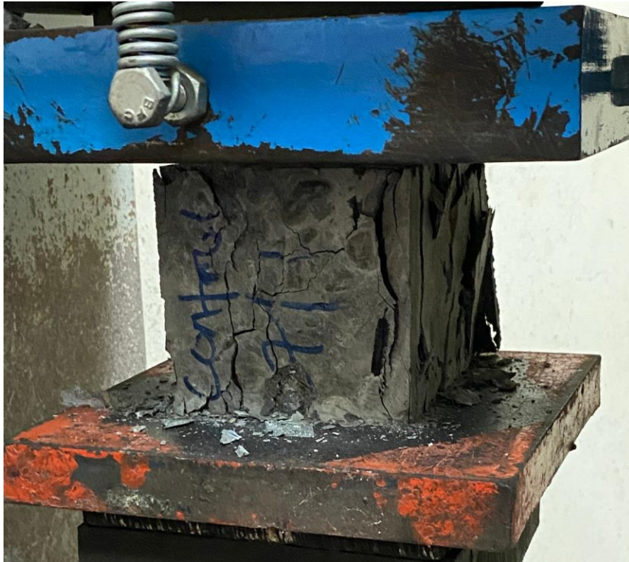
รูปที่ 37 การทดสอบกำลังรับแรงอัดของคอนกรีต
