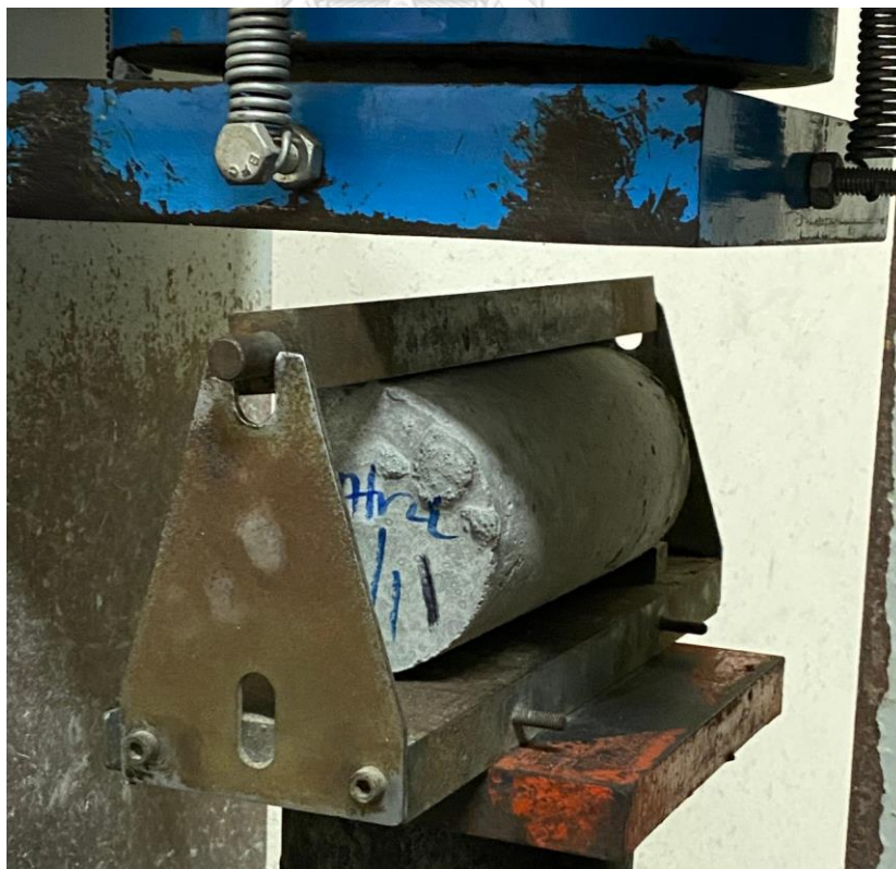
รูปที่ 38 การทดสอบกำลังรับแรงดึงแยกของคอนกรีต
