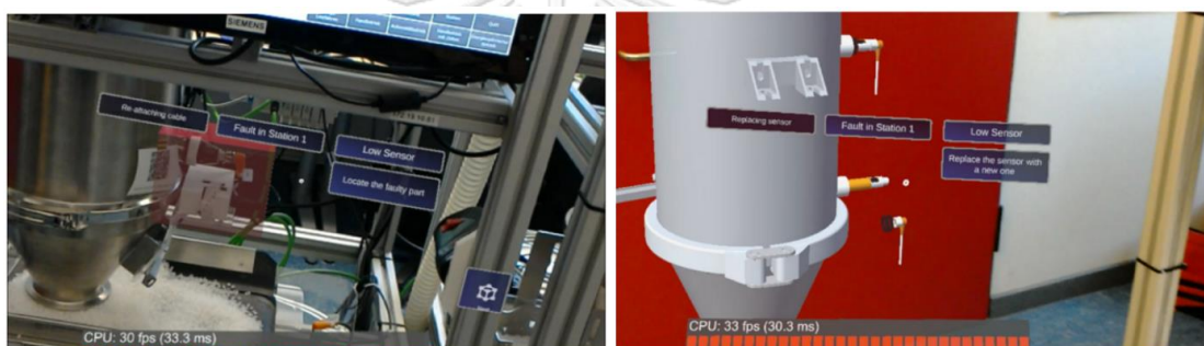
รูป 3 ภาพการแสดงผลบนแว่น Microsoft HoloLens ที่ซ้อนทับกับอุปกรณ์ในโลก Physical [5]
