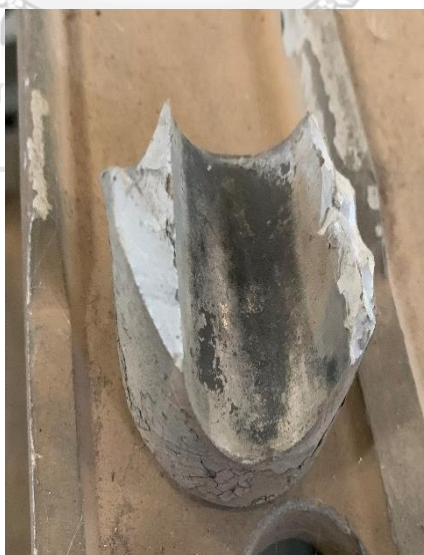
รูปที่ 54 เศษชิ้นส่วนของสลักสะพานทหาร เอ็ม จี บี ที่ชำรุด
