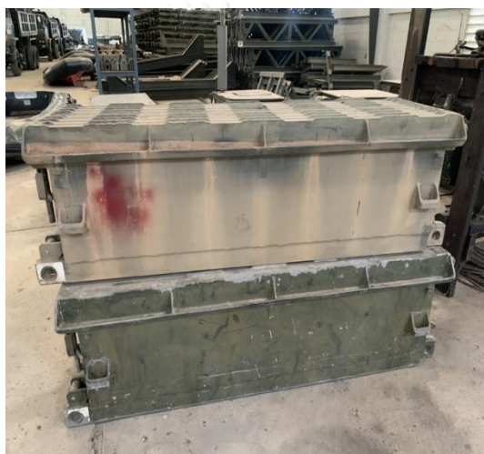
รูปที่ 2 ชิ้นส่วนโครงบนสะพาน เอ็ม จี บี
