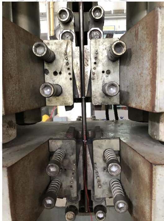
รูปที่ 55 การยึดจับวัสดุทดสอบ S45C ด้วยเครื่องทดสอบอเนกประสงค์ พร้อมติดตั้งอุปกรณ์วัดความเครียด
