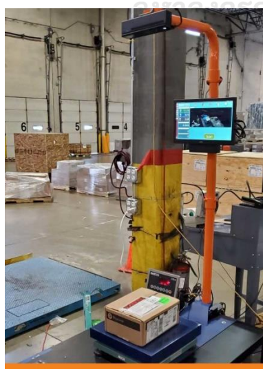
รูปที่ 25 เครื่องวัดขนาดกล่องพัสดุที่ใช้ในระดับอุตสาหกรรม [24]
