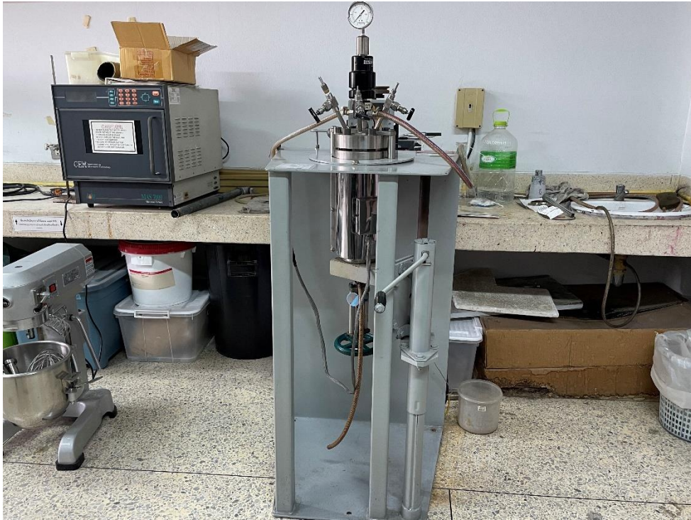
ภาพที่ ก.1 เครื่องนึ่งอัดไอที่ใช้ในการทดลอง
