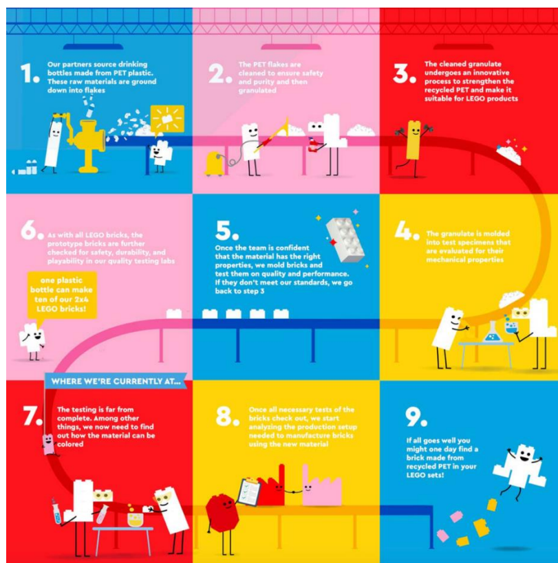
ภาพที่ 0.93 ขั้นตอนผลิตต้นแบบเลโก้ (LEGO) จากพลาสติกรีไซเคิล (Recycle)
